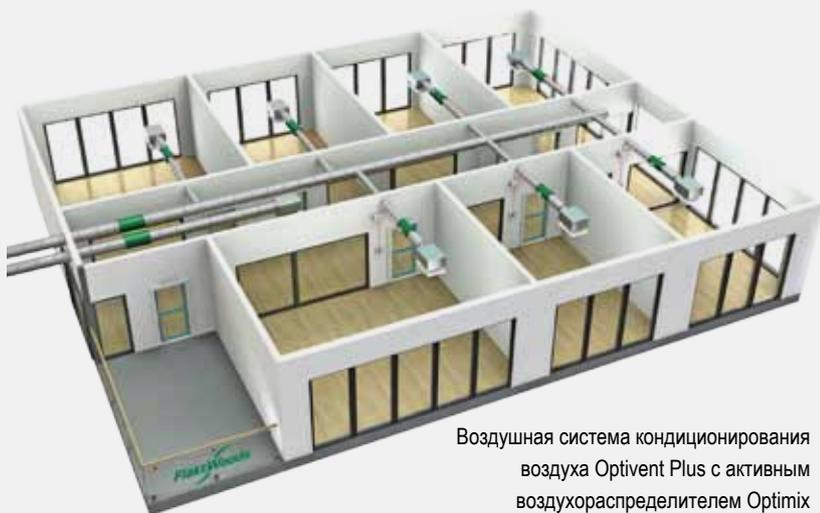
Воздушная система кондиционирования воздуха Optivent Plus с активным воздухораспределителем Optimix
